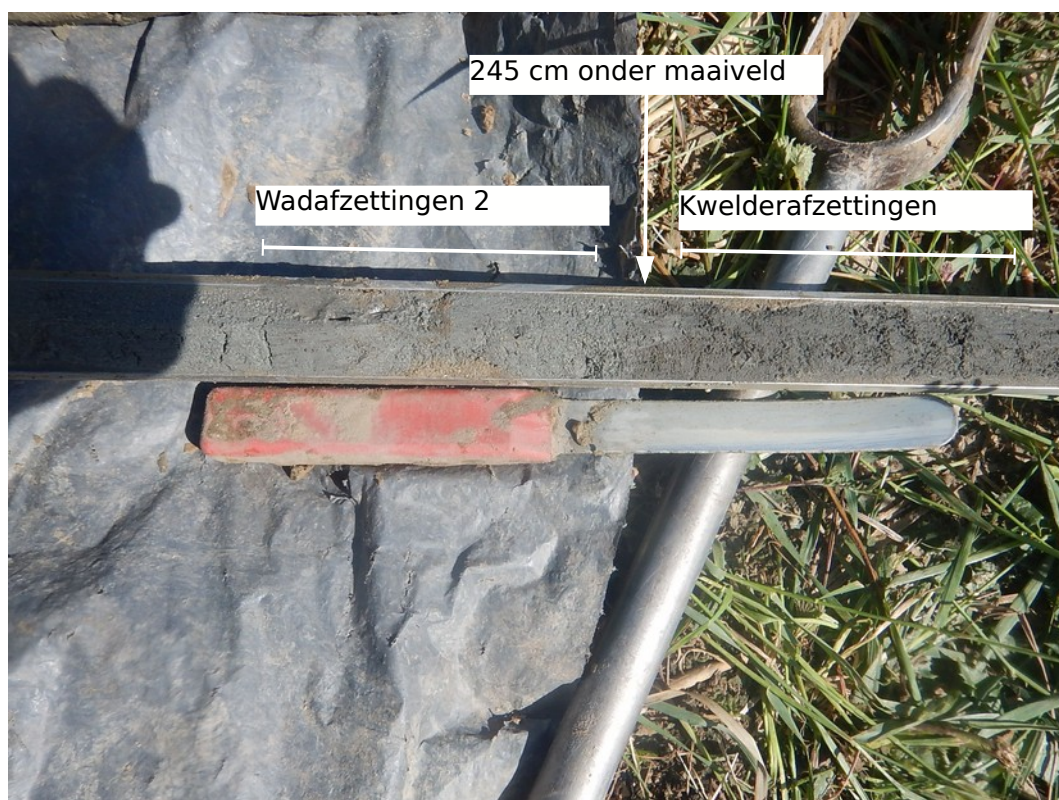
Figuur 13: Foto van overgang van wadafzettingen 2 naar wadafzettingen 1 bij boring 7.
