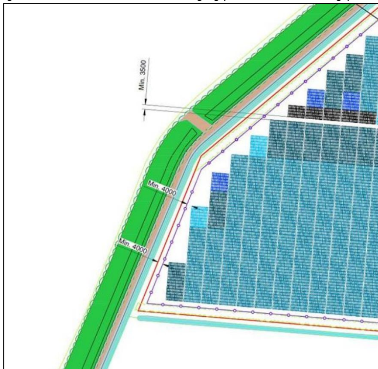
figuur 21. Afstand tussen hekwerk en watergang (uitsnede technische design)
