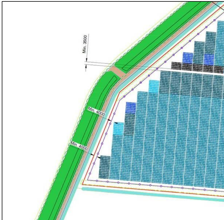
figuur 20. Afstand tussen hekwerk en watergang (uitsnede technische design)
