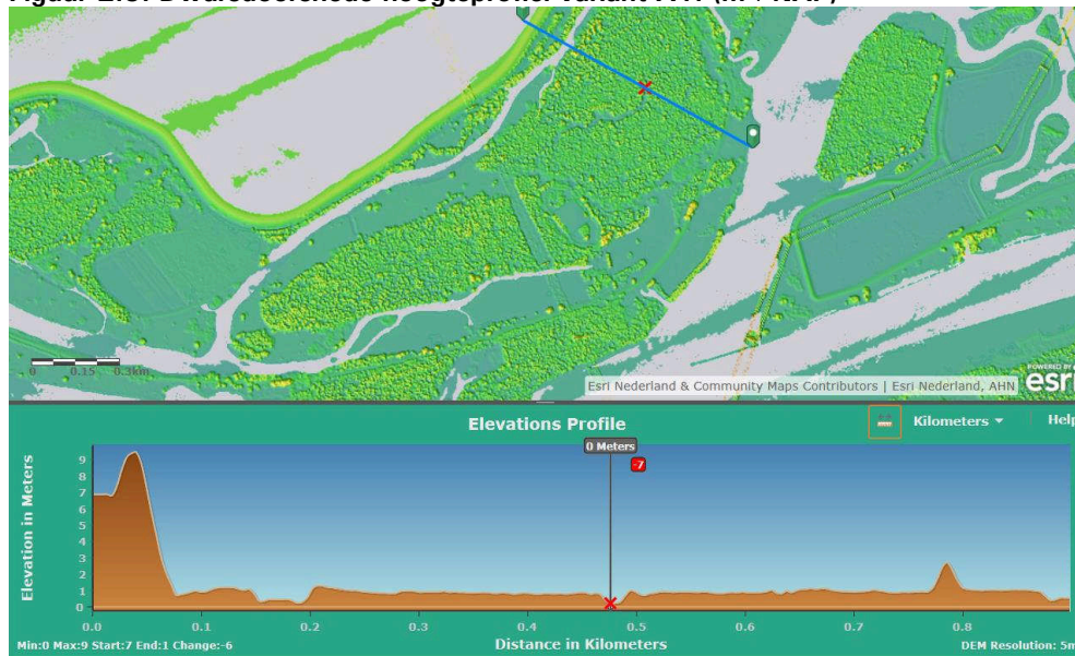
Figuur 2.6: Dwarsdoorsnede hoogteprofiel variant B2: (m + NAP)
