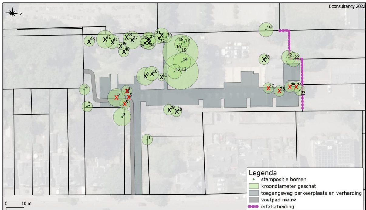
Figuur 9. Aanleg infrastructuur en op voorhand niet te behouden bomen (zwarte x door bebouwing en obstakelvrije zone, rode x door aanleg infrastructuur).
