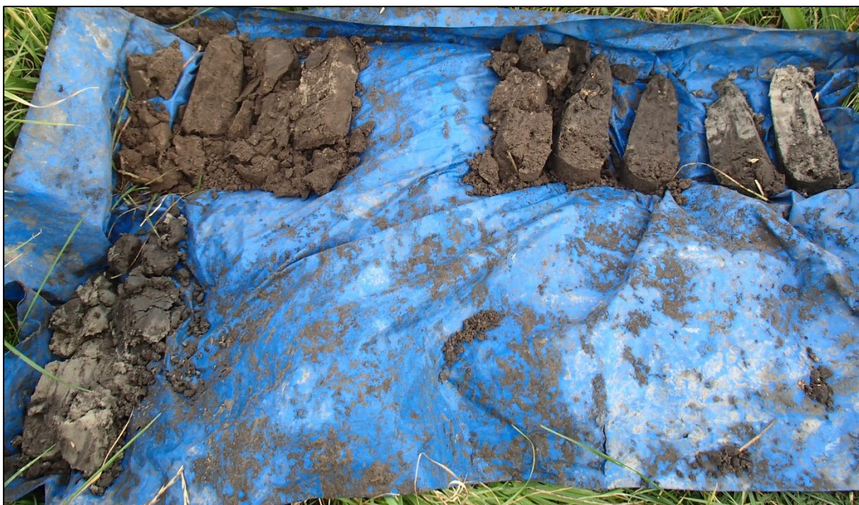
Boring 4: 0 – 120 cm –Mv. Deze boring werd gestaakt door de aanwezigheid van nat zand. Hierbij vielen de monsters uit de boor.
