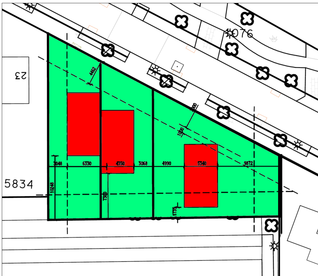
Uitgangsmodel 0 uitgewerkt tot verkevelingstekening. De tweekapper kan zowel getrapt (zoals weergegeven) worden uitgevoerd, dan wel met gelijkliggende voorgevels
