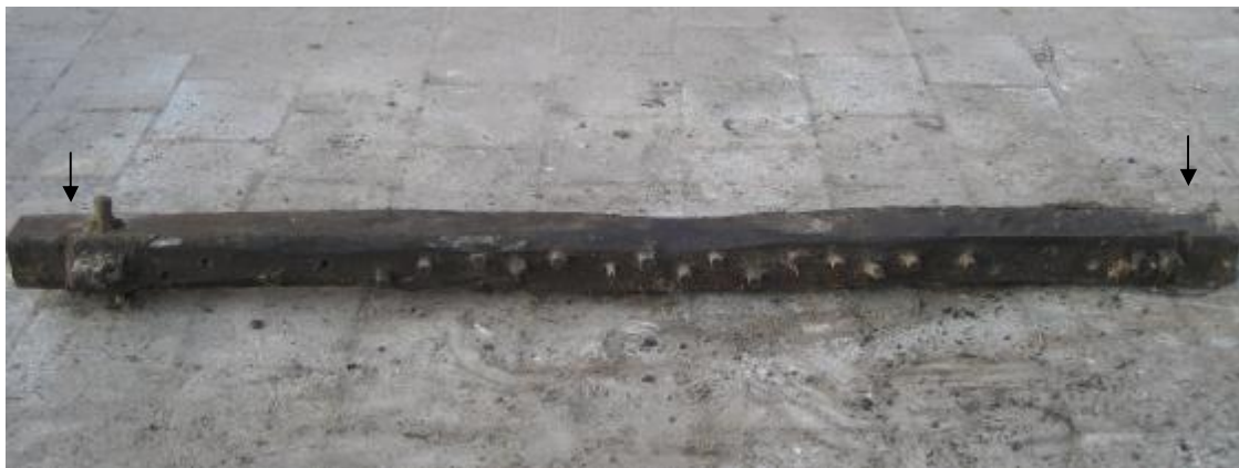
Afbeelding 6: een van de houten balken die werd aangetroffen als afval in de loop binnen de bekisting van fase 2. Links en rechts (pijltes) zijn de inkepingen zichtbaar waarmee deze op de bekisting rustte en stevig bleef zitten. Ook zichtbaar in het midden zijn de pennen waarmee de huiden konden worden vastgebonden.
