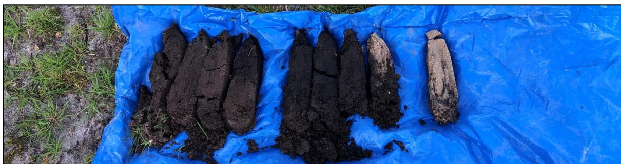
Boring 3: 0-110 cm -Mv. Dieper gelegen sediment loopt uit de boor onder invloed van grondwater.
