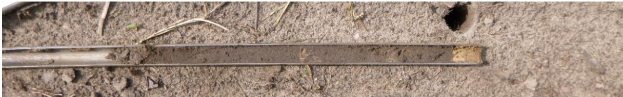
Figuur 21: Foto van de direct op de C-horizont gelegen bouwvoor zoals deze in boring 5 is aangetroffen.
