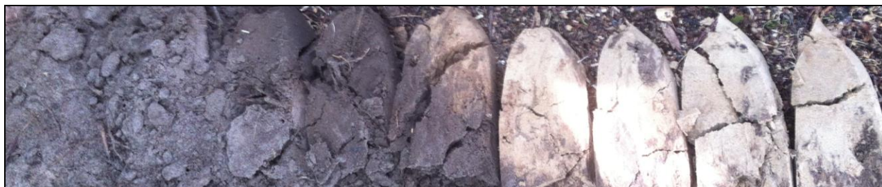
Figuur 4: boorkern van boring 3, één van de minder geroerde overgangen.
