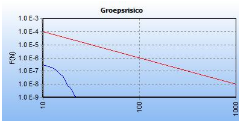
Figuur 29: FN curve behorend bij de boven aangegeven kilometer leiding.
