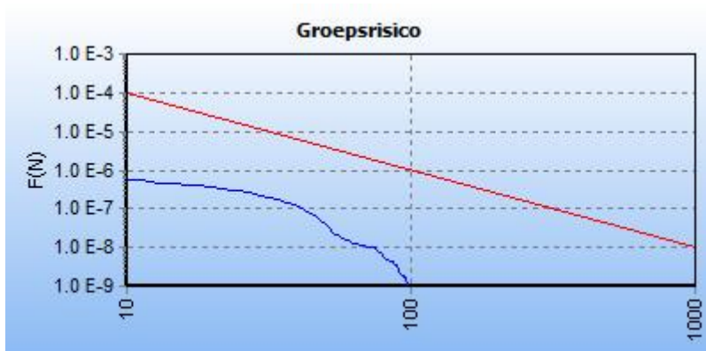
Figuur 25: FN curve behorend bij de boven aangegeven kilometer leiding.
