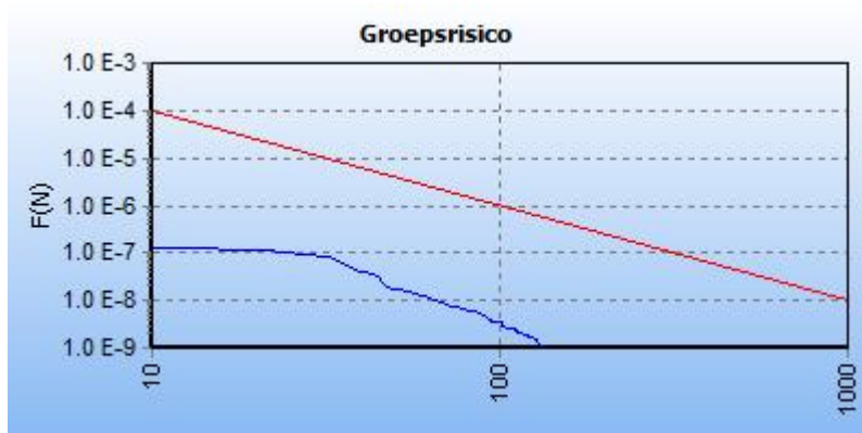
Figuur 15: FN curve behorend bij de boven aangegeven kilometer leiding.
