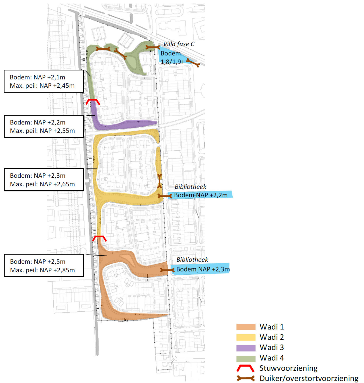
Afbeelding 4.7: Overzicht systeem waterberging plangebied Lommerrijk.
