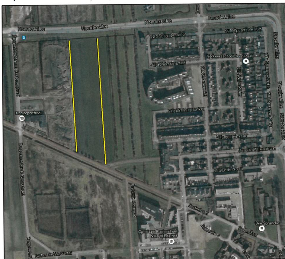
Figuur 4. Te dempen sloten ter plaatse van locatie 6 (gele lijnen).
