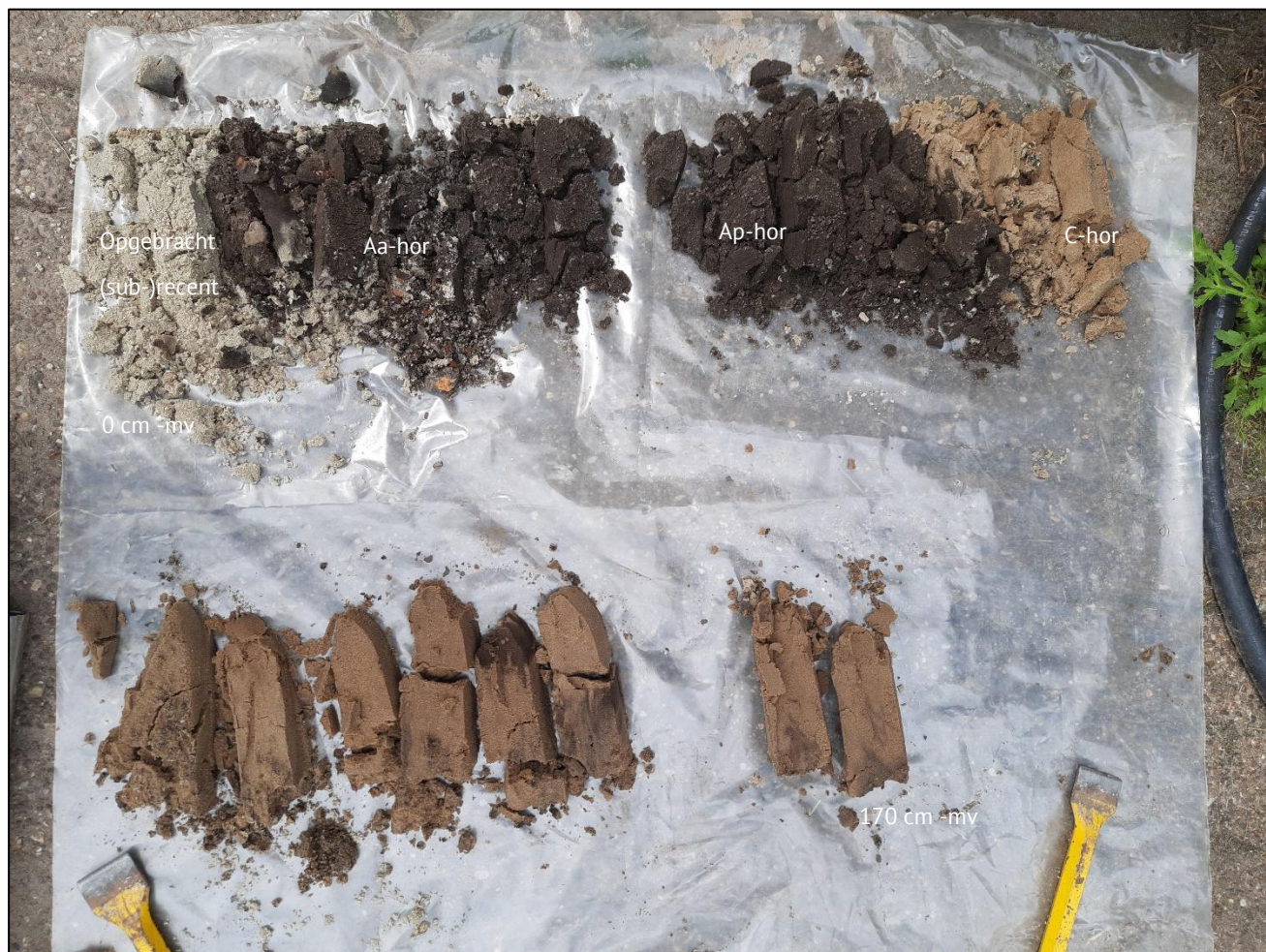
Figuur 9: Foto van boorprofiel 2. De leesrichting is van linksboven naar rechtsonder. (0 – 170 centimeter)
