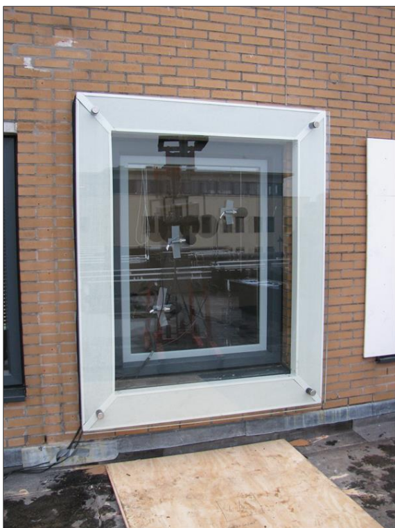
Foto II.3 Aanzicht glazen gevelgeluidscherm
