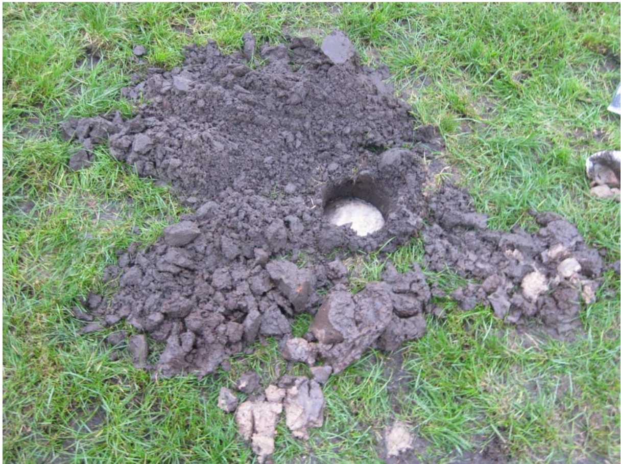
Figuur 13: De hoge grondwaterstand in boring 20.
