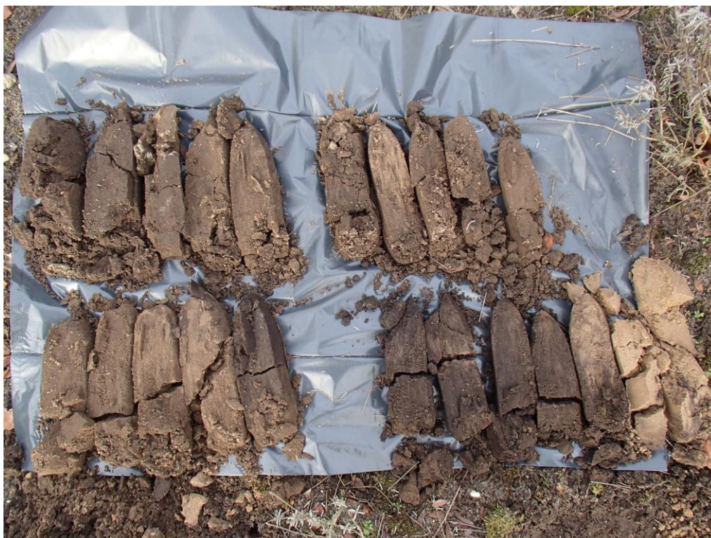
Boring 1: Overzicht boorkernen (uitgelegd van linksboven naar rechtsonder).
