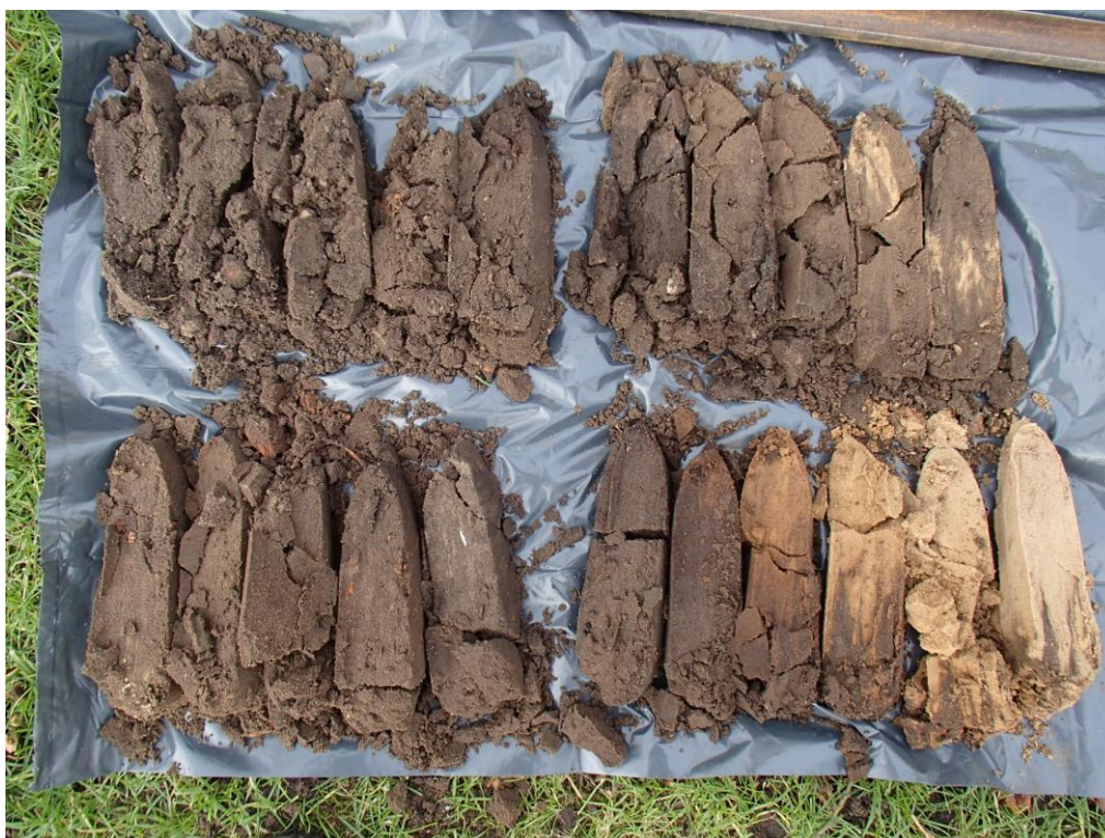
Boring 2: Overzicht boorkernen (uitgelegd van linksboven naar rechtsonder).
