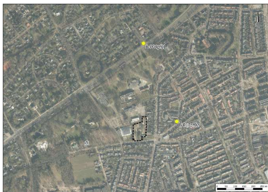
Figuur 3.2 Situering gebruikte grondwaterpeilputten
