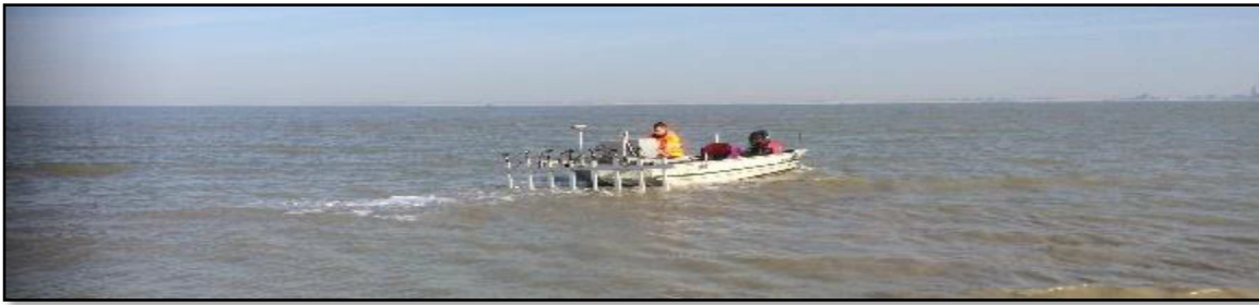
Uitvoeren passieve NON realtime waterbodemdetectie m.b.v. detectieboot.
