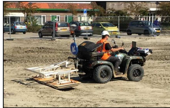
De 3D grondradar achter een quad
