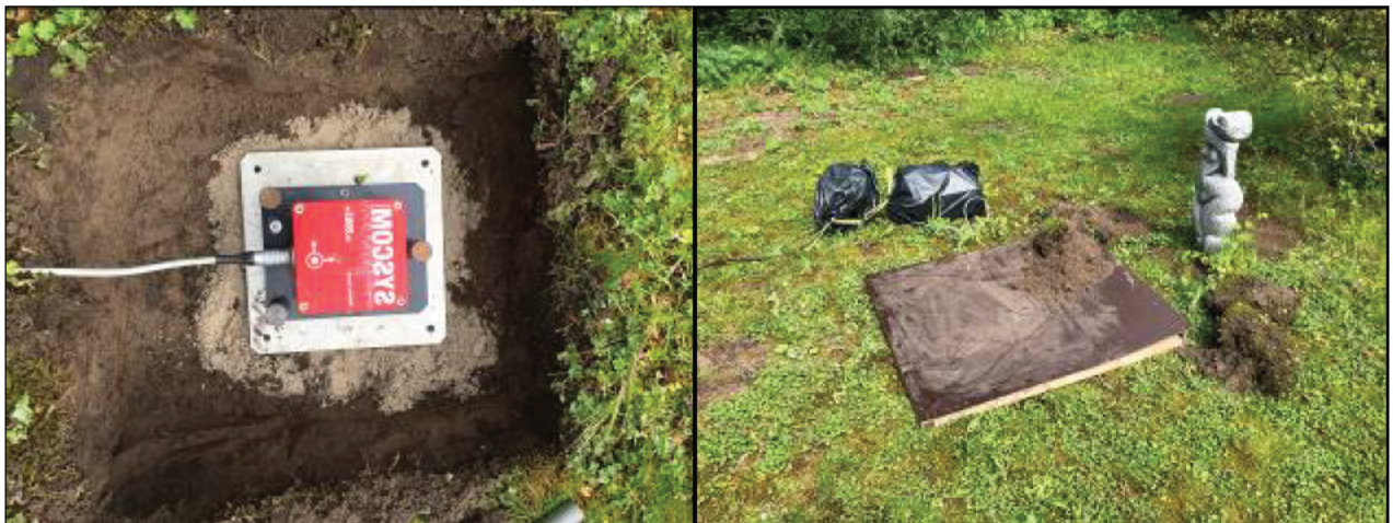
Figuur 3.2: Meetopstelling van het rechter meetpunt op maaiveld (woning noord)
