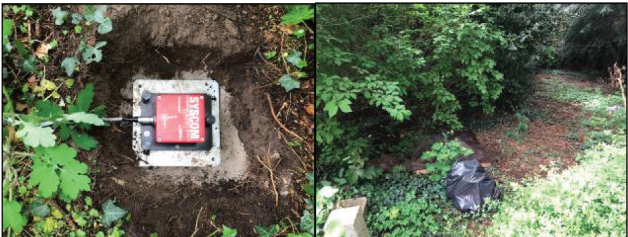
Figuur 3.3: Meetopstelling van het linker meetpunt op maaiveld (woning zuid)
