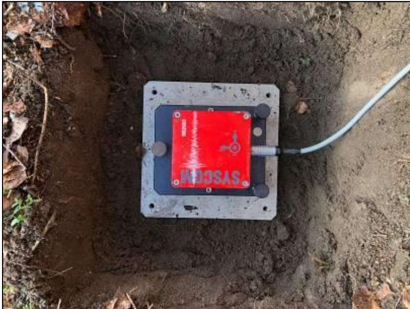
Figuur 3.2: voorbeeld meetopstelling trillingsopnemer op bodemplaat
