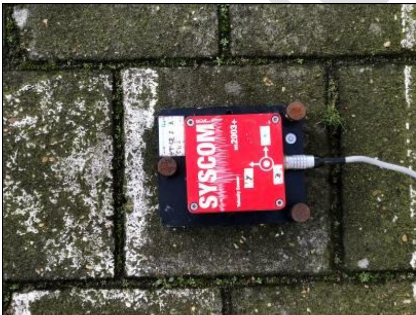
Figuur 3.3: voorbeeld meetopstelling trillingsopnemer op tegel
