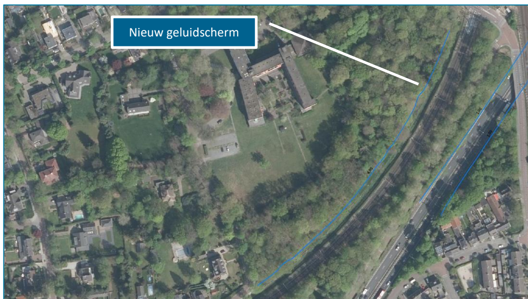
Afbeelding 5.1 Te realiseren absorberend geluidscherm, 290 m lang en 4,0 m hoog ten opzichte van het lokale maaiveld
