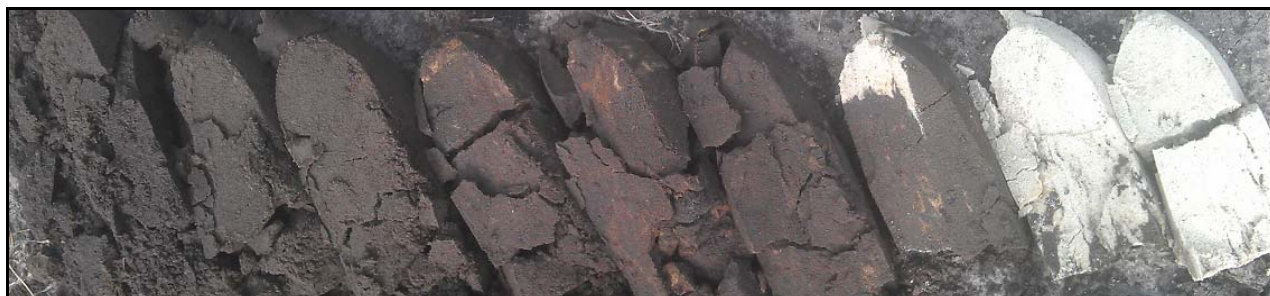
Figuur 6: boring 4: donkere, sterk humeuze Ap-horizont met sporen houtskool op een cremewit matig siltig zandpakket
