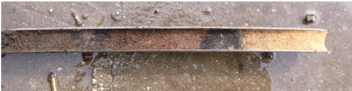
Figuur 22: Foto van het laagje sterk veraard veen dat in 4 is aangetroffen.
