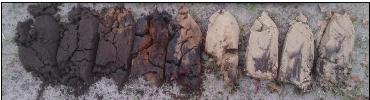
Figuur 8: Profiel van boring 5 met brokken B-Horizont in de toplaag en sporen van een verstoring tot diep in de C-Horizont.
