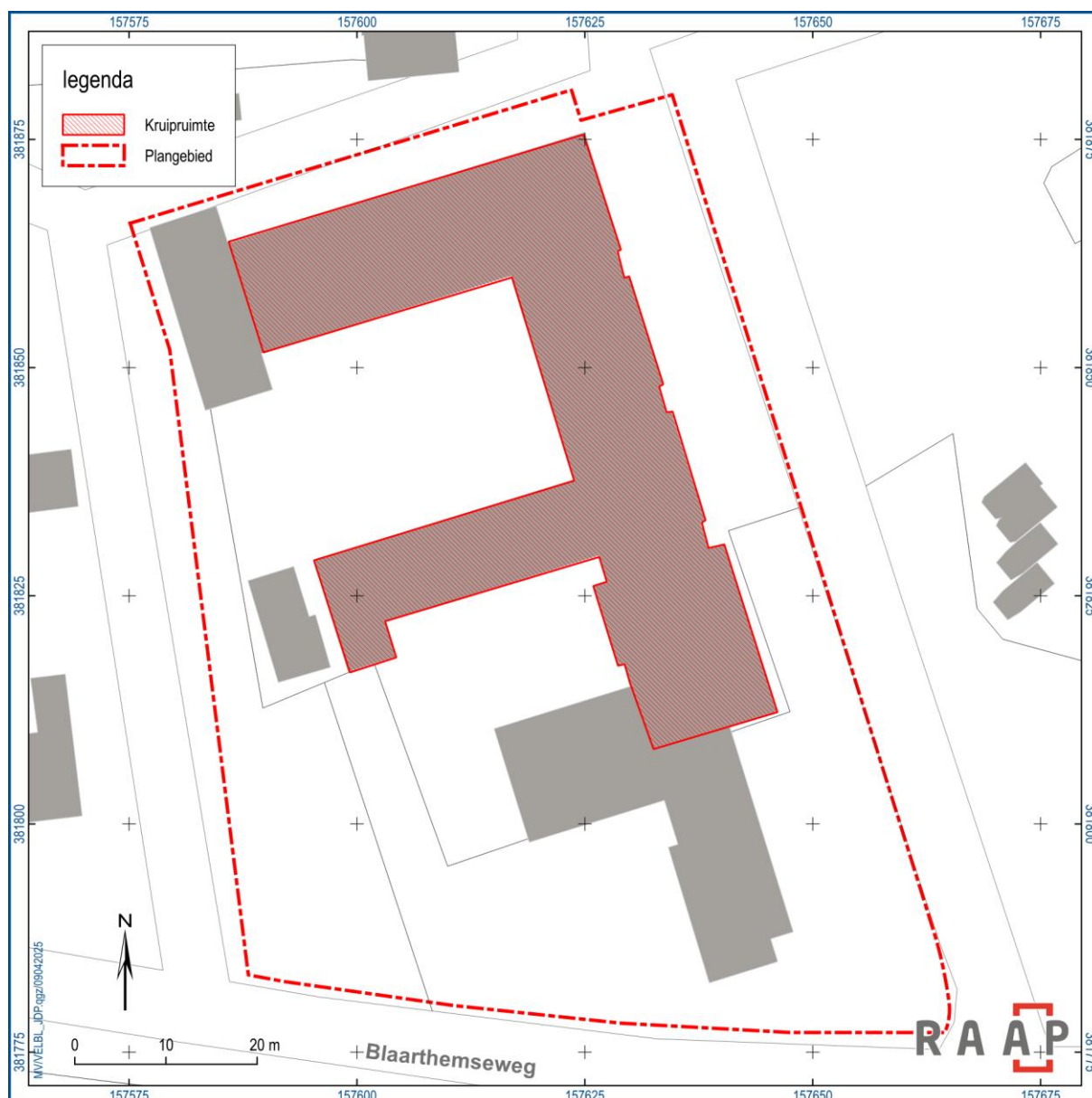
Figuur 9. De gebouwen met ca. 1.10 m diepe kruipruimtes.
