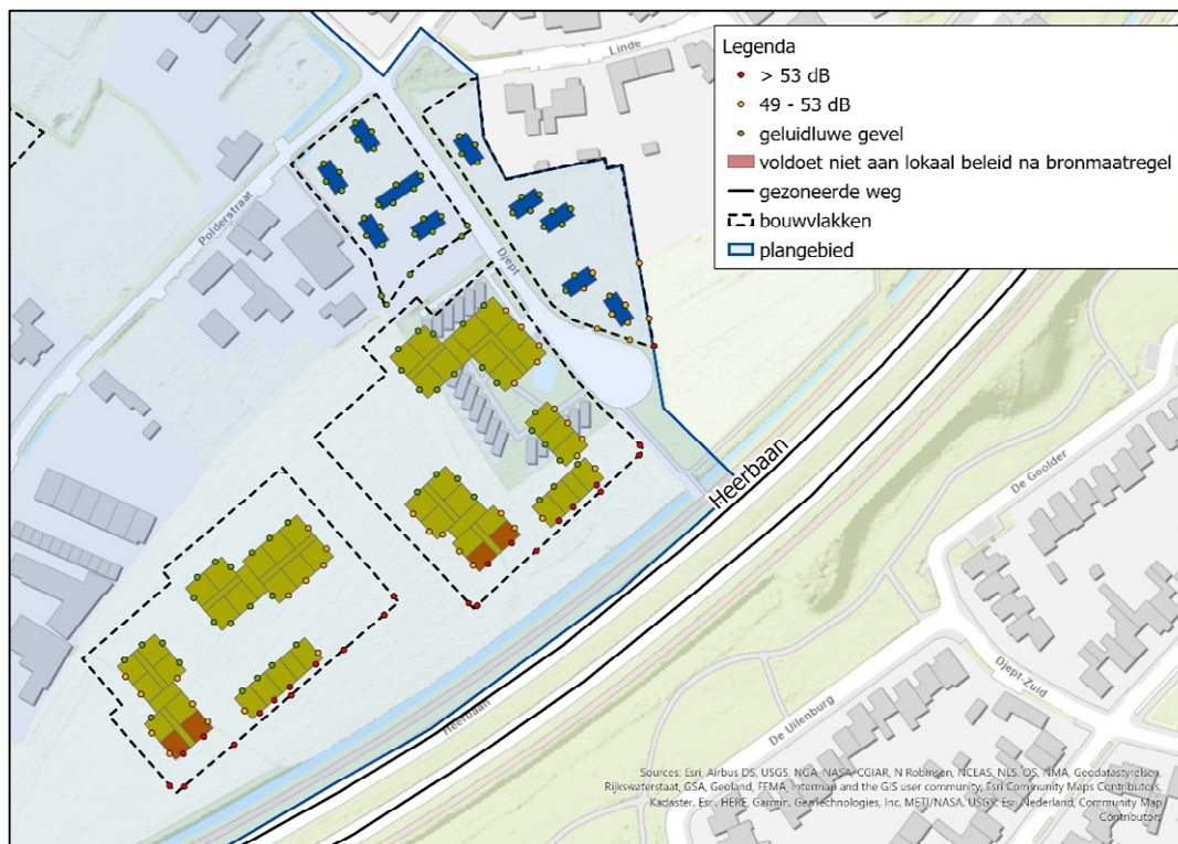
Figuur 4.7 Geluidbelasting als gevolg van verkeer op de Heerbaan na toepassing van de voorstelde bronmaatregel ten behoeve van de toets aan het lokale geluidbeleid.
