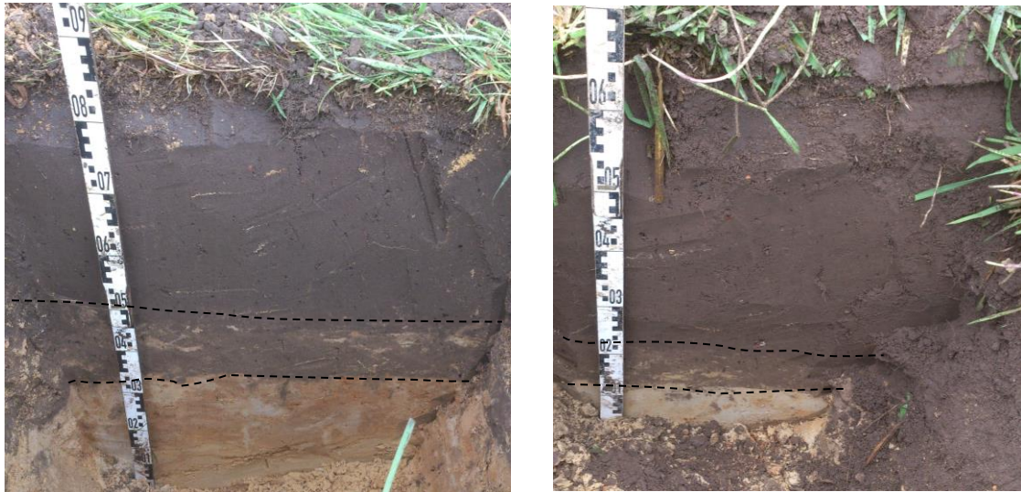
Figuur 9: De profielopbouw ter hoogte van boring 14 (links) en 15 (rechts). Met de stippellijn is de grens tussen het akkerpakket, de verspitte laag en de natuurlijke bodem aangegeven.
