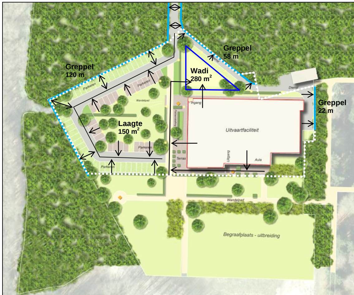
Figuur 1: Situatie met waterbergingsvoorzieningen en afwateringsrichtingen
