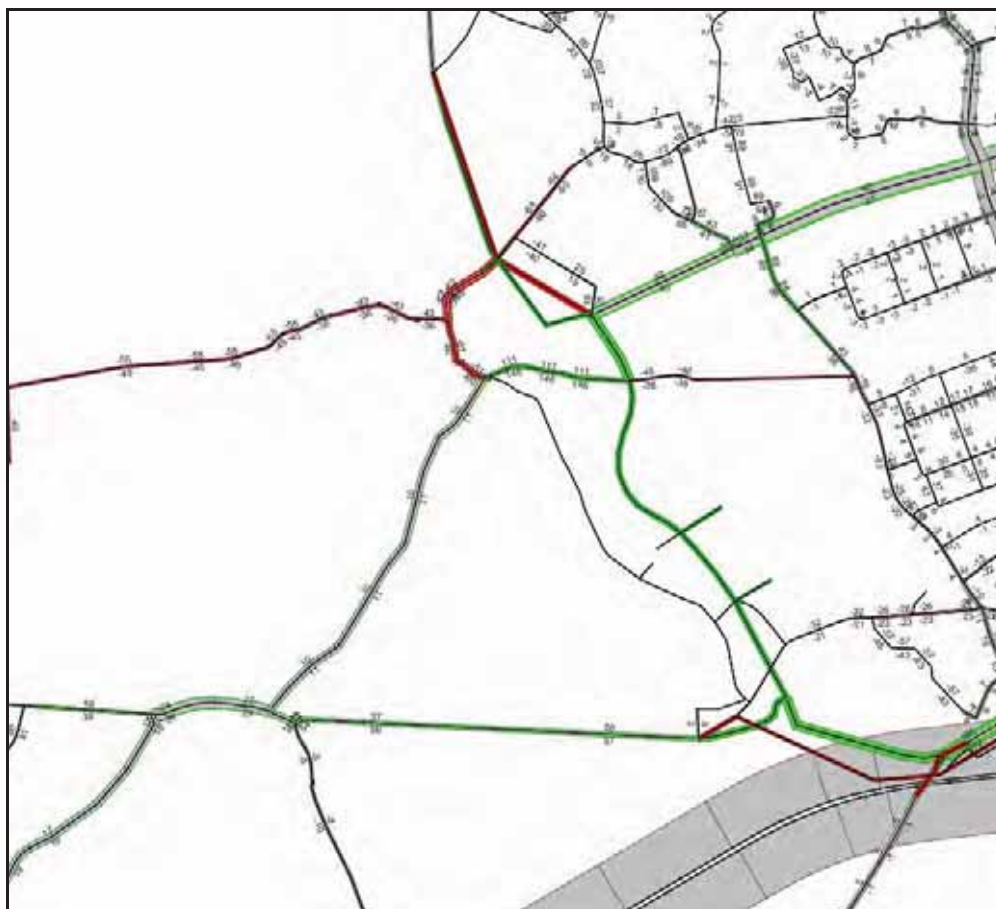
Figuur 4.2: Verschilplot intensiteiten WOR (fase 2) variant 4 – zichtjaar 2021; procentuele af- en toenames ten opzichte van autonoom
