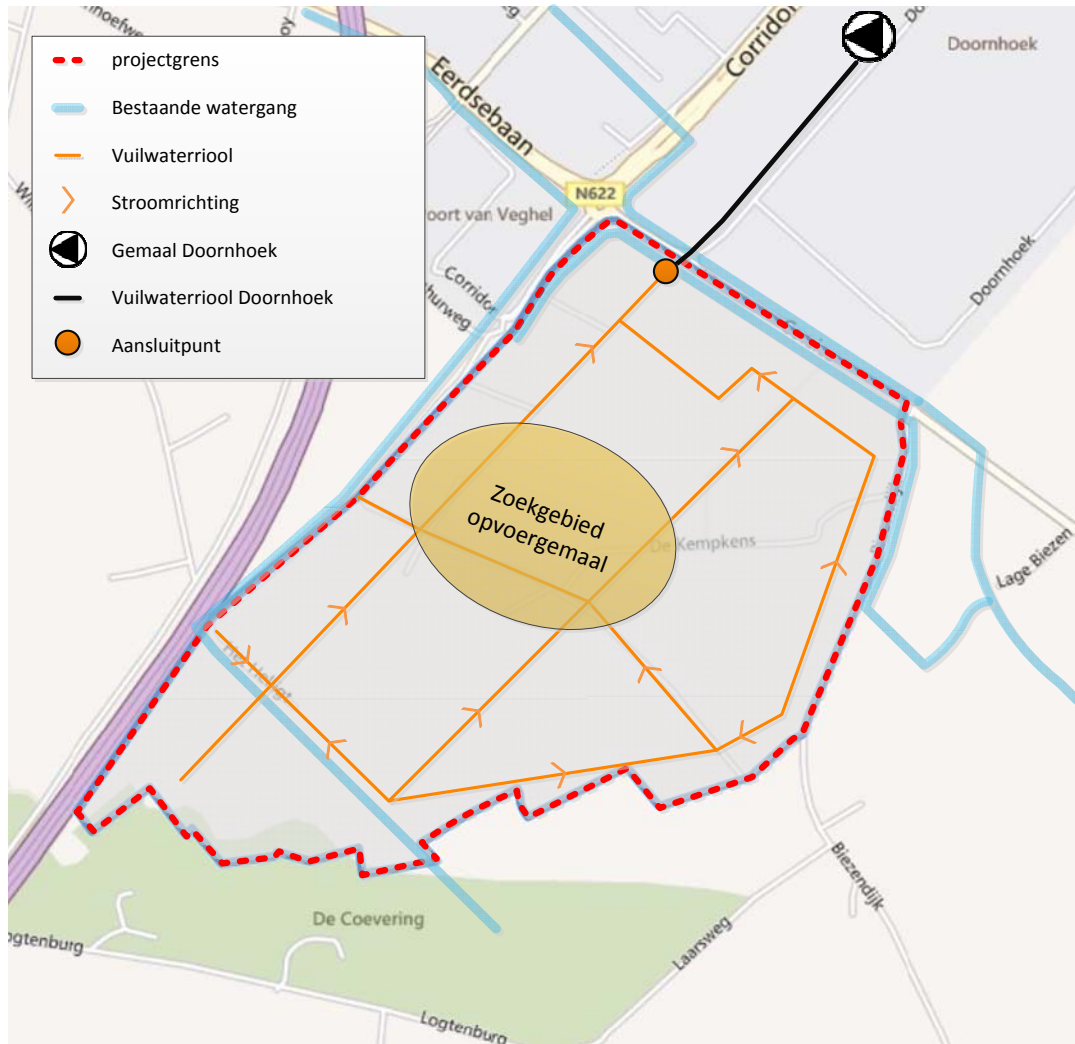
Figuur 12: Schetsontwerp afvalwaterriolering bij fictieve verkaveling
