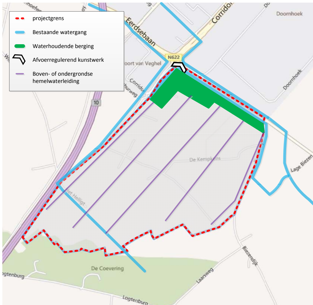
Figuur 11: Schetsontwerp oppervlaktewater en hemelwaterafvoer
