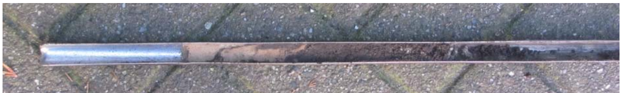
Figuur 15: Foto van boring 2 met links het met brokken humusrijk vermengde gele zand en rechts de onderkant van de vergraven toplaag.
