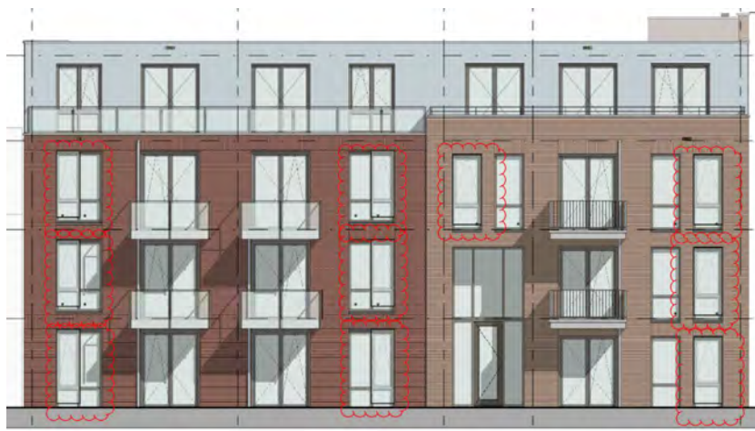
Figuur 9: De gevel met daarin aangegeven (rood omlijnd) de betreffende balkons (voorzetschermen) welke aan de gestelde eisen dienen te voldoen.
