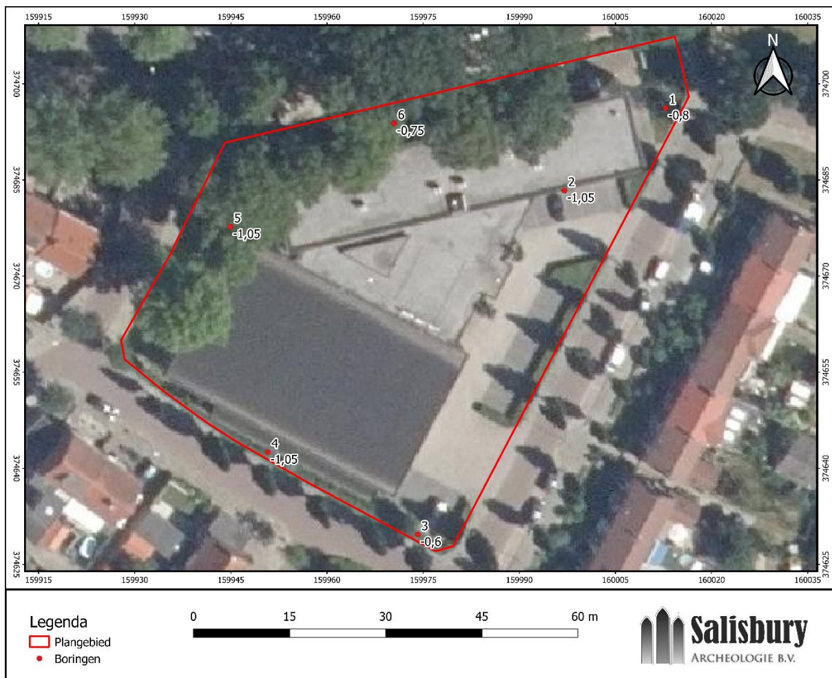
Afb. 15. Resultaten van het booronderzoek met de verstoringsdiepte in meters beneden maaiveld.
