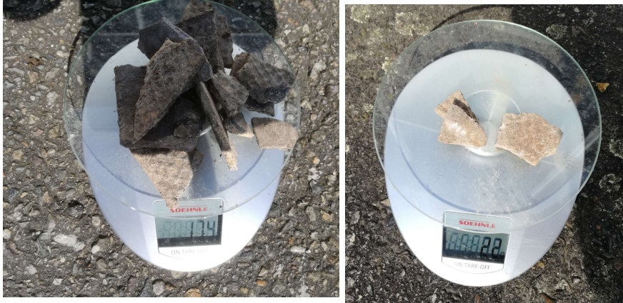
Asbestgolfplaat in gat 214 en 215
