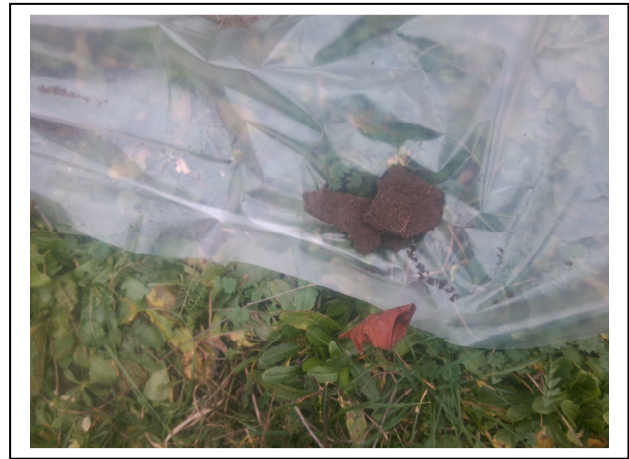
Foto 14. Asbest plaatmateriaal asbestinspectiegat A11
