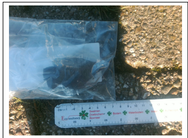
Foto 16. Asbest plaatmateriaal asbestinspectiegat A12
