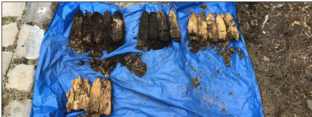
Boring 1: 0-200 cm -Mv. Dieper gelegen sediment loopt uit de boor wegens grondwater.
