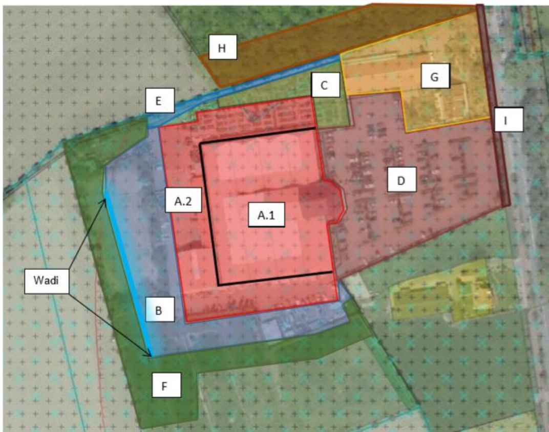
Figuur 4.8 beoogde nieuwe situatie afwatering/gebruik hemelwater
