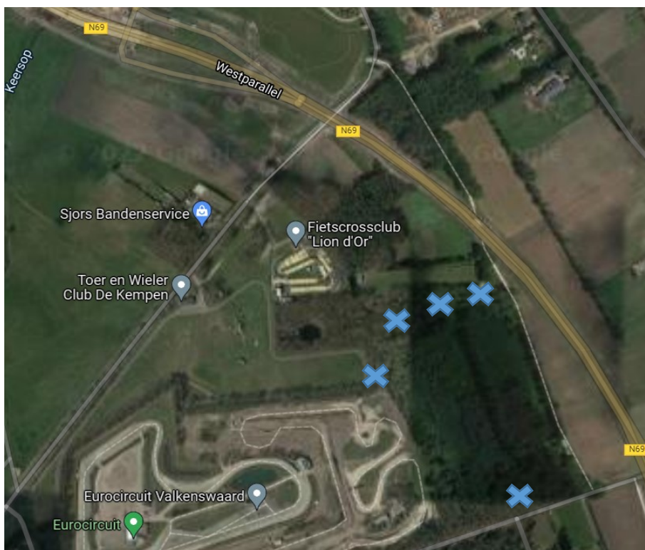
Figuur 2 Peilbuislocaties grondwateronderzoek Tritium Advies (kenmerk: I604/012/MV-01, d.d. 25 oktober 2016). Het zuidelijke kruisje geeft de bovenstroomse locatie aan en de andere kruisjes de benedenstroomse peilbuizen.
