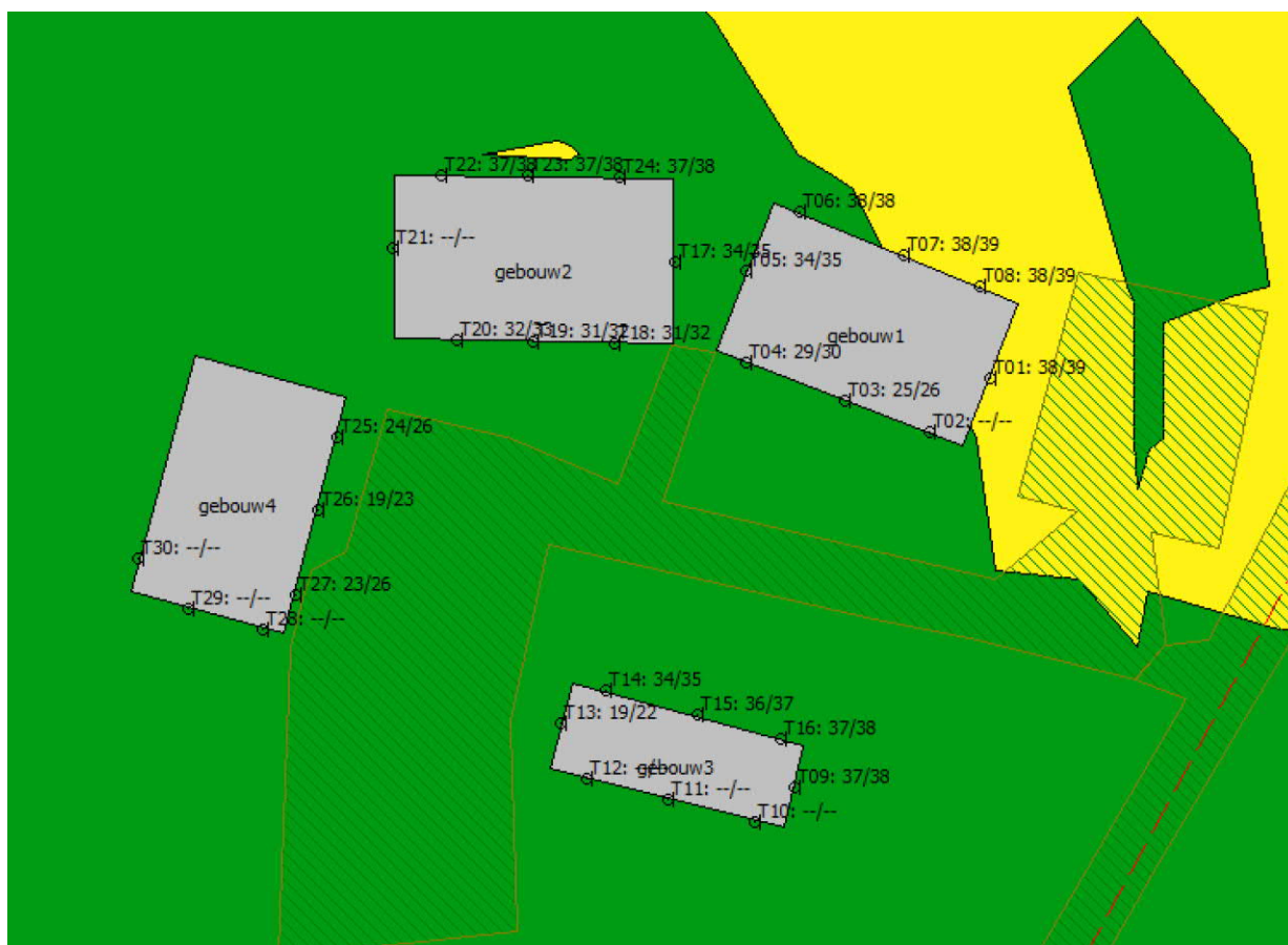
Figuur 4: Geluidbelasting ten gevolge van wegverkeerslawaai incl. aftrek volgens art. 110g Wgh ten gevolge van wegverkeer op de Nieuwe Waalreseweg
