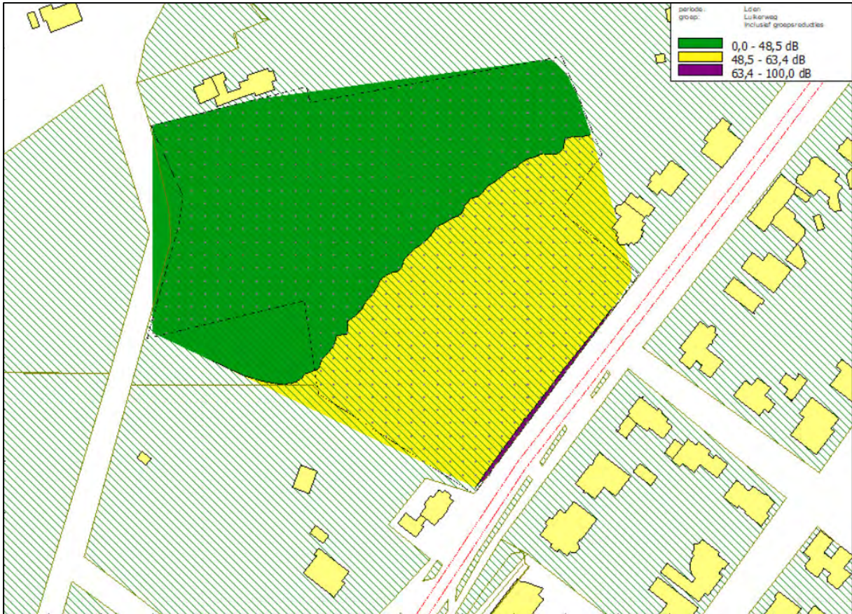
Figuur 4.2: geluidbelasting t.g.v. het wegverkeer op de Luikerweg incl. aftrek artikel 110g Wgh (gridhoogte 4,5 meter)
