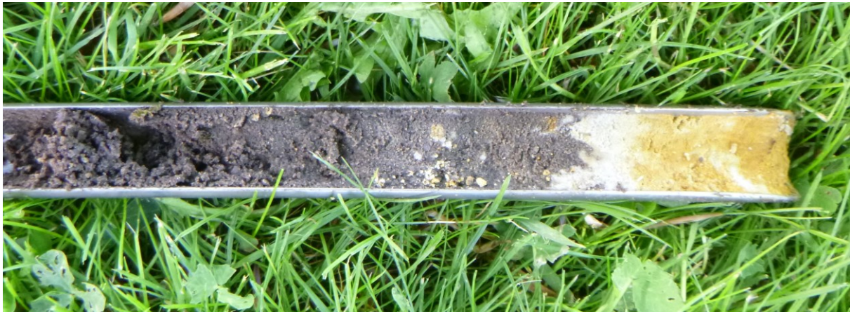
Figuur 23: Foto van de door sterk wisselende oxidatie- en reductie omstandigheden gekenmerkte bodemhorizont (rechts), die is aangetroffen op de boorpunten 1, 5, 9, 16, 19, 20, 31 en 34.
