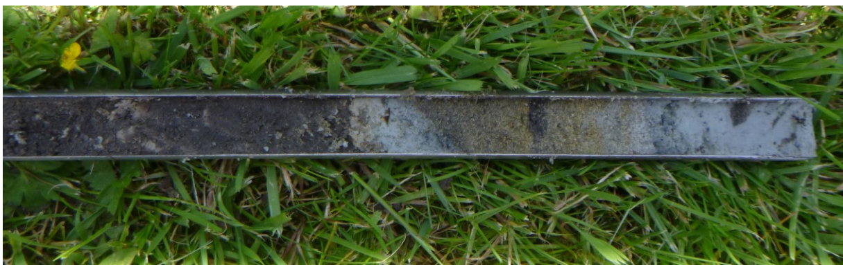
Figuur 22: Foto van de voor het plangebied kenmerkende, rommelige toplaag met daaronder een doorgraven zandlaag die met name bestaat uit brokken geel geoxideerd en ongeoxideerd grijs zand en daaronder de C-horizont van ongeoxideerd, grijs zand.
