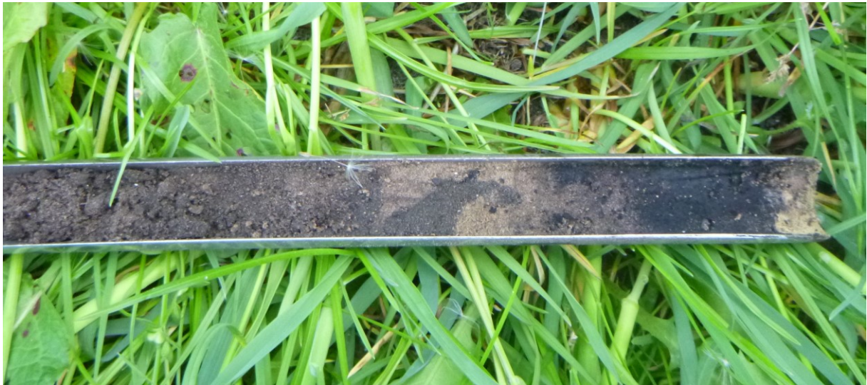
Figuur 24: Foto van het veenrestant (rechts) dat in boring 21 is aangetroffen.
