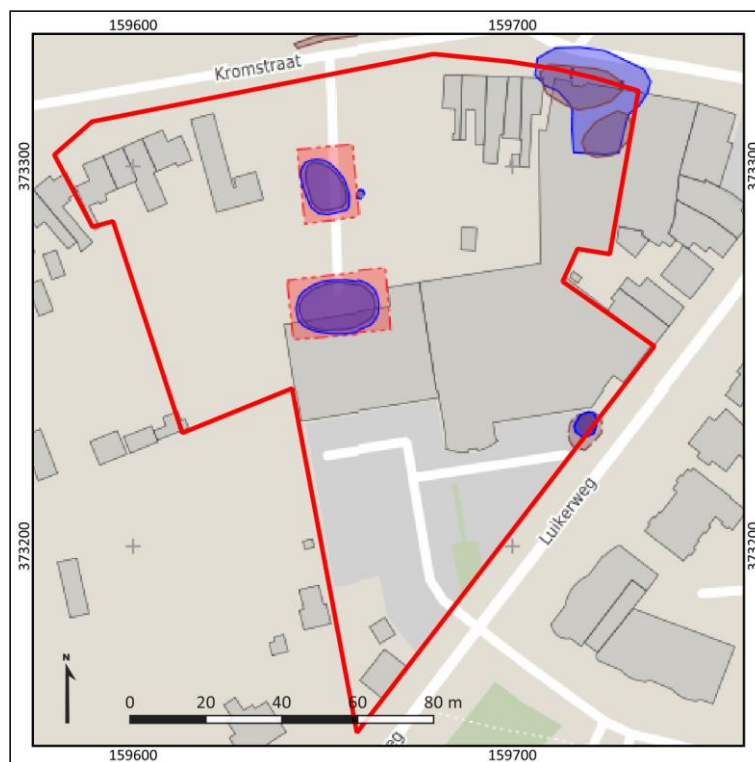
Figuur 9. Reeds bekende vervuilingen (in blauw) en uitgevoerde saneringen (in rood) in het plangebied ( noord-brabant.omgevingsrapportage.nl ).
