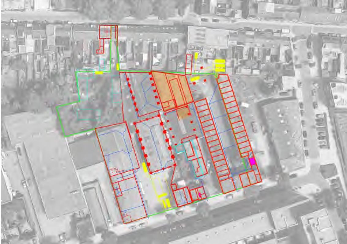
Afbeelding 3.4.1 verstoringskaart plangebied. De strokenfunderingen zijn in rood weergegeven, bouwputten in oranje, kelders in paars, riolen in blauw, onbekende gebouwen in lichtblauw, ondergrondse olietanks en leidingen in geel. Het plangebied is groen omkaderd. Deze kaart is ook opgenomen in Bijlage 6.
