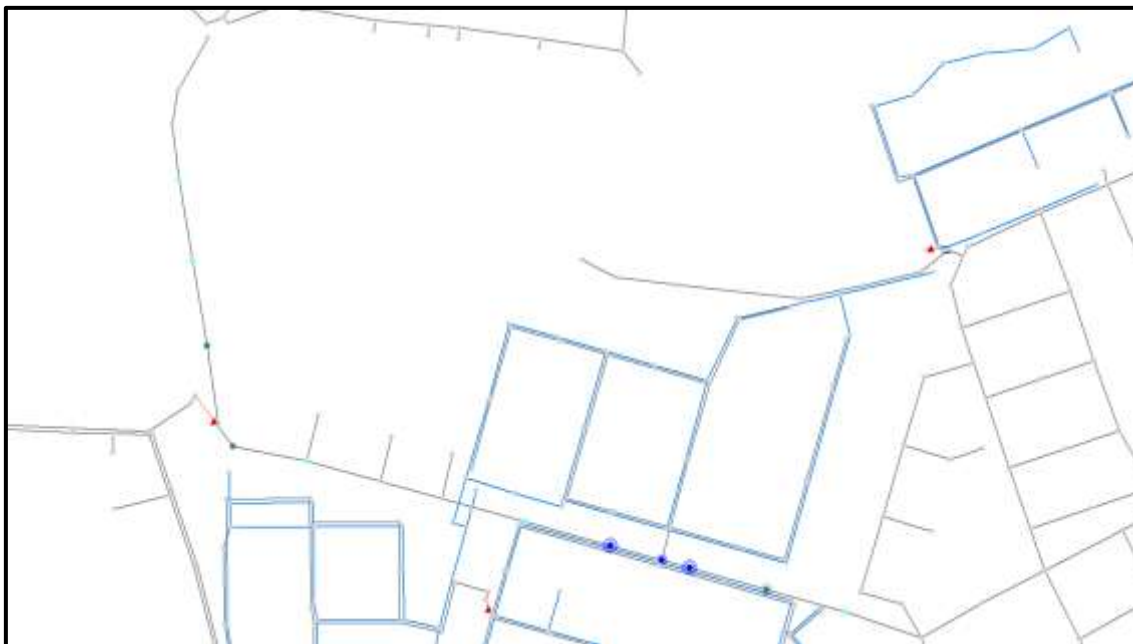
Afbeelding 22: Water op straat Silvrettapad en Berglandweg na doorvoering van Blauwe Ader Moerenburg, maxima bij bui 8.
