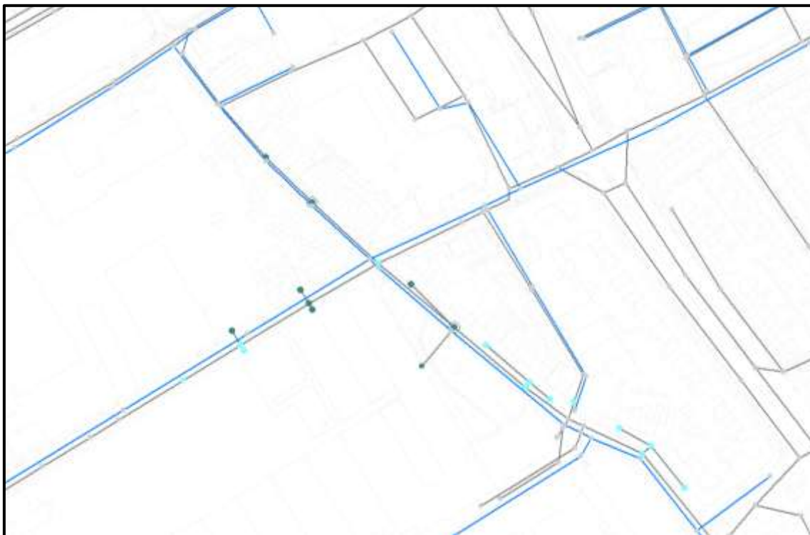
Afbeelding 20: Resultaten hydraulische berekening, maxima bij bui 8, Fatimastraat en Hoevenseweg.
