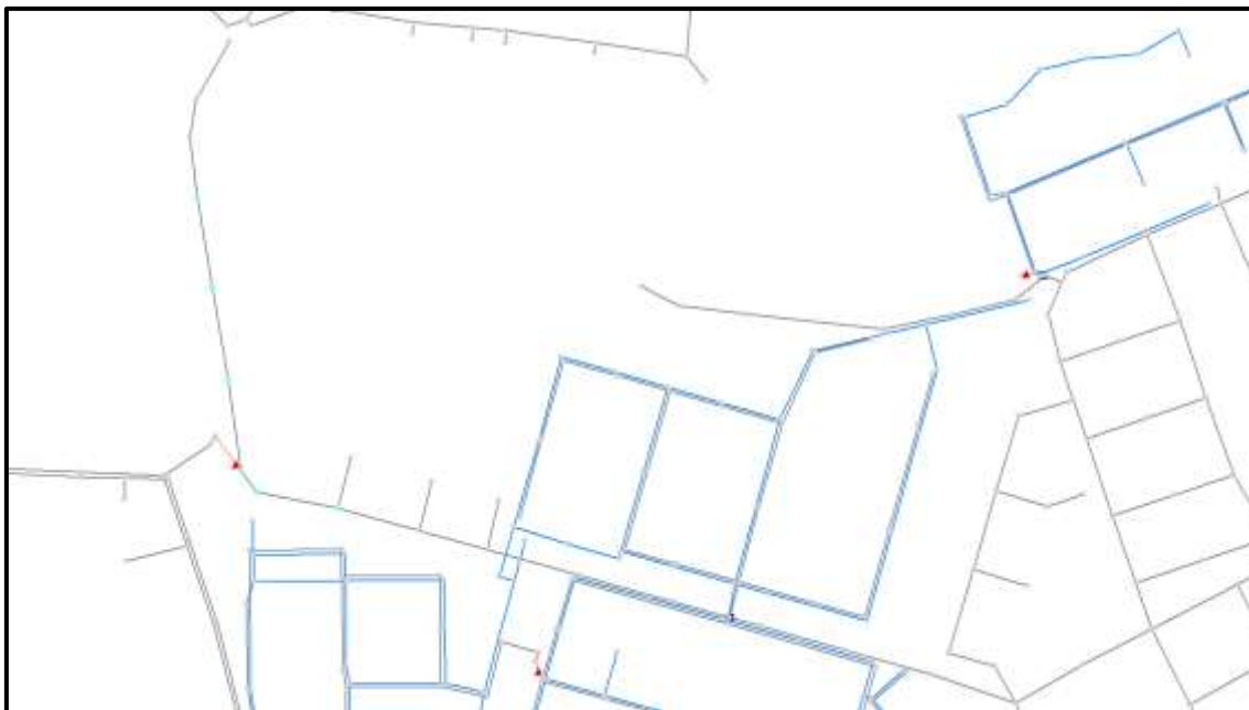
Afbeelding 23: Water op straat Silvrettapad, Eifelweg en Tatraweg bij toepassing van een drempel op het RWA-stelsel van gebied Groenwoud, maxima bij bui 8.
