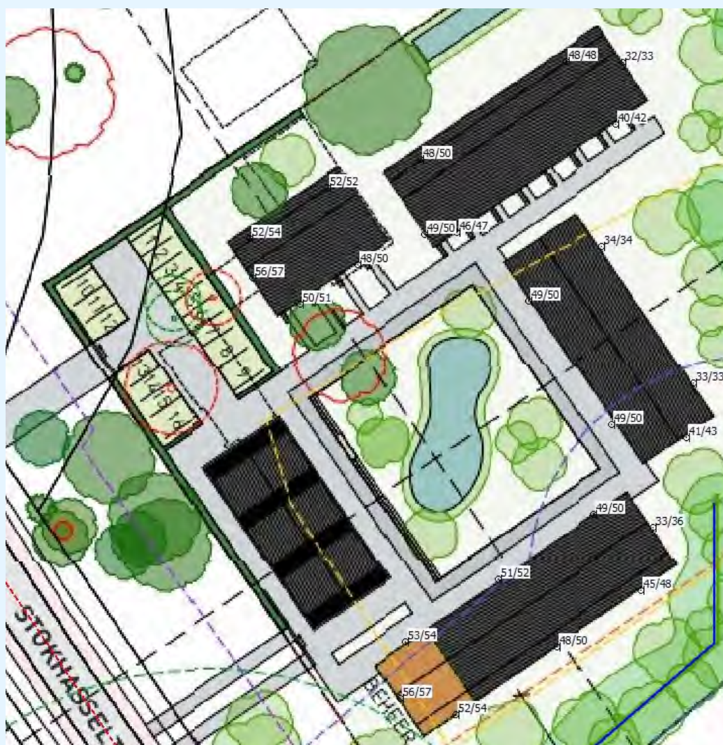
figuur 5: geluid in L_{den} per bouwlaag door de gemeentewegen in dB
