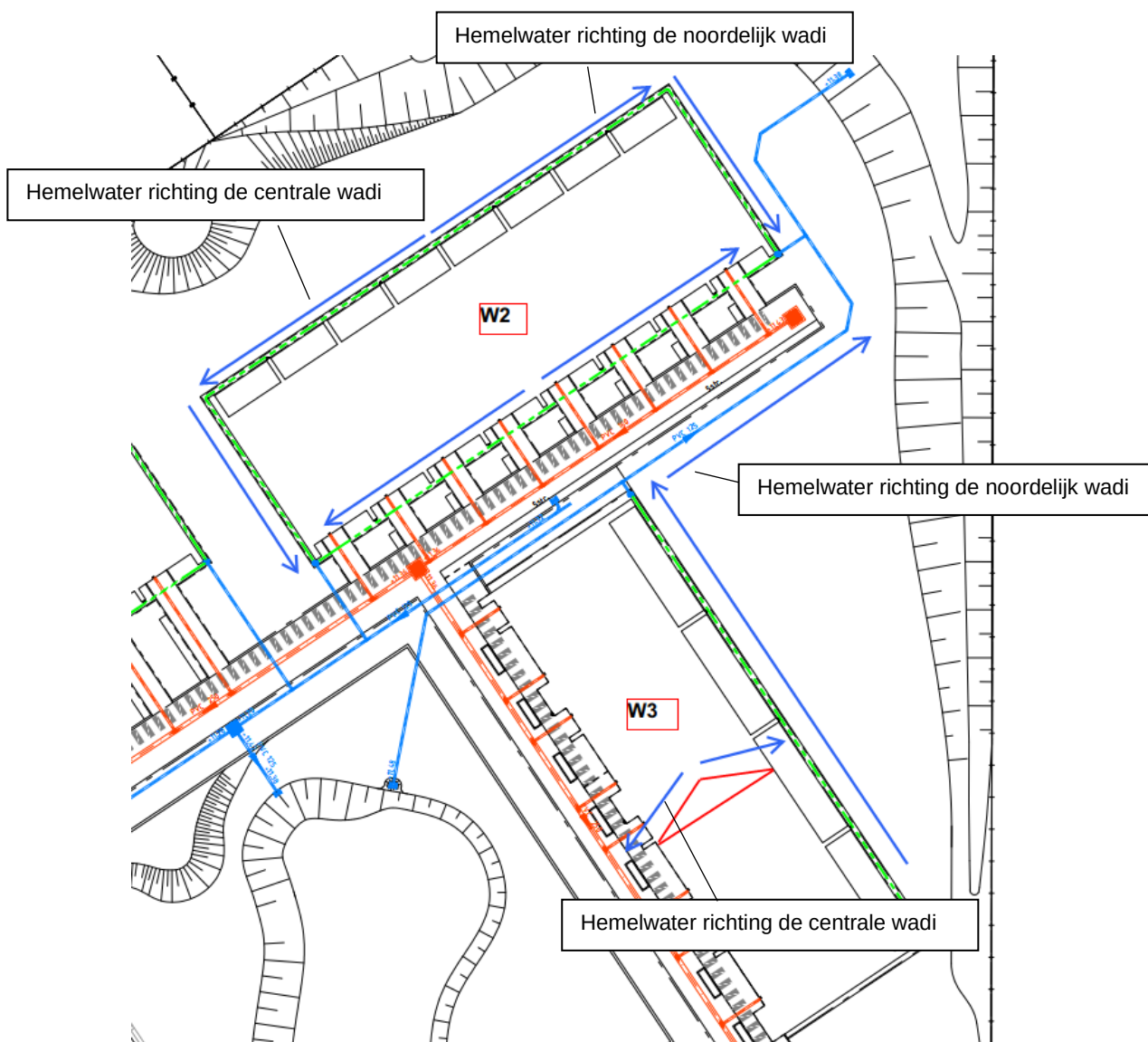
Figuur 4 Afwatering Woonblokken W2 & W3
