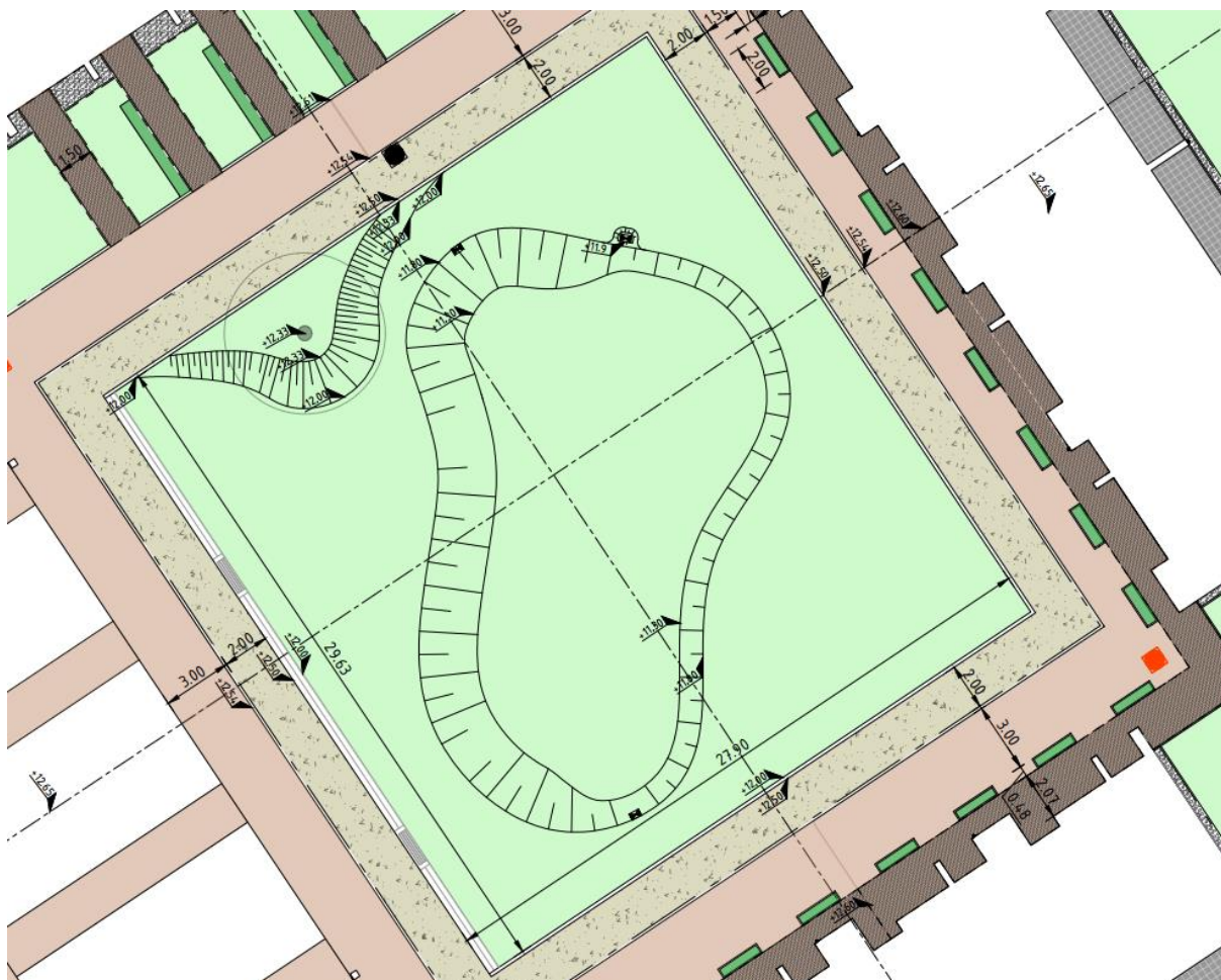
Figuur 3 Hoogteverloop centraal gelegen wadi
