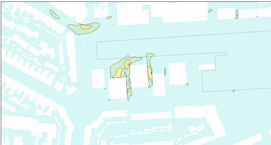
Figuur 2 - Windhinder op voetgangersniveau na realisatie van de Hopleidenkade bij bladdragende vegetatie (lente/zomer)
