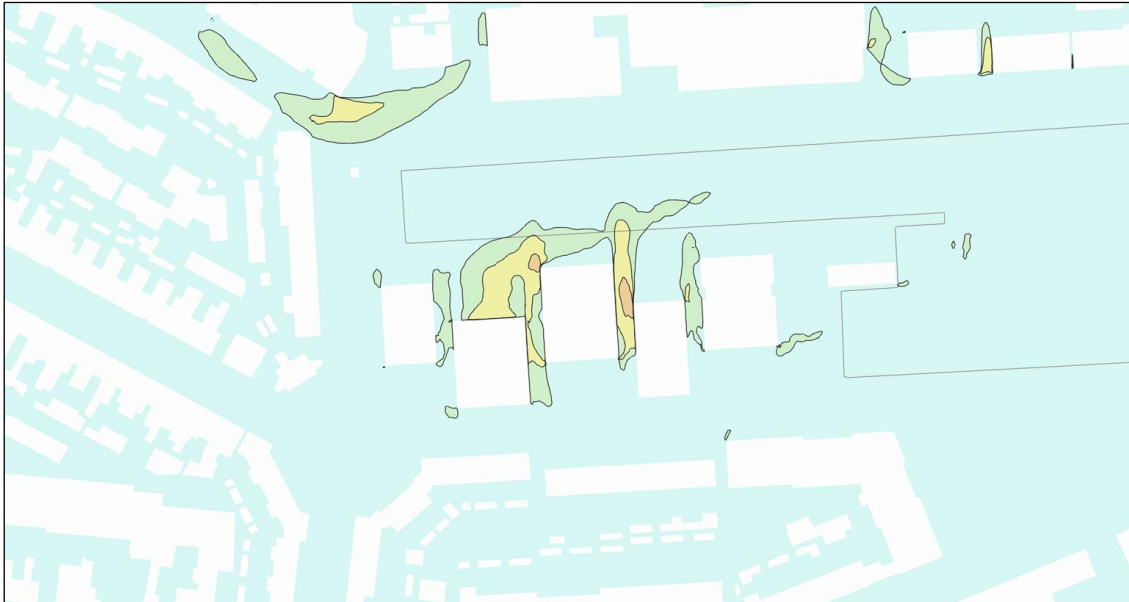
Figuur 1 – Windhinder op voetgangersniveau na realisatie van de Hopleidenkade, jaargemiddeld
