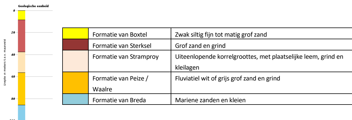
Figuur A: opbouw ondergrond.
