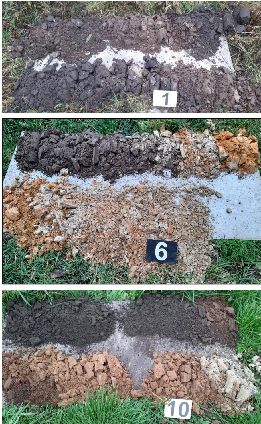
Afbeelding 4: Profielboring 0 tot max 2 meter diep. Profiel leesbaar vanaf linksboven (maaiveld) naar rechtsonder (eigen foto: 31 januari 2022)
